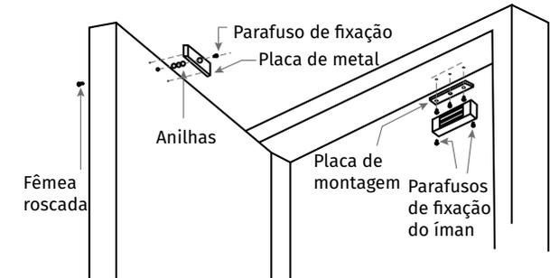
Não fixe a placa de metal com demasiada força, de maneira a que a borracha fique mais flexível, para que a placa se ajuste automaticamente à posição correta do ímã.
